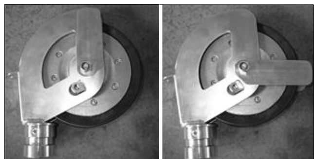
Bild 5.27 Minischwenkrolle, (rechts) Abstandhalter für Seilschutz-Profil abgeklappt
