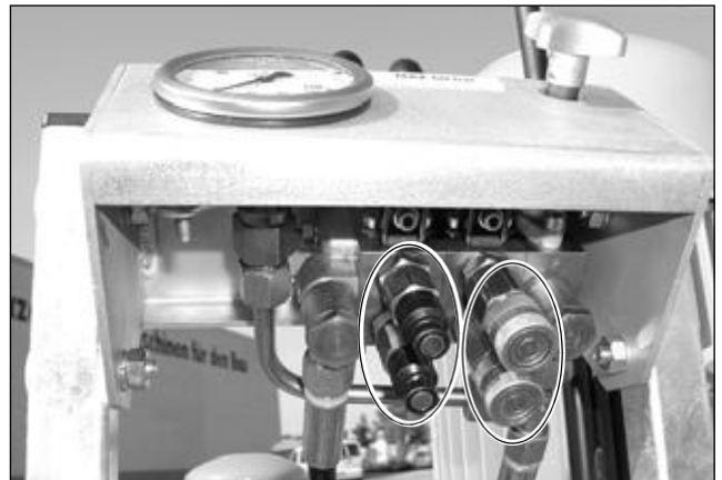
Bild 5.45 Kupplungen (der 2 möglichen Steuerblöcke) für den hydraulischen CSA•100 H Vorschub am (unter dem) optionalen Steuerpult des optionalen Hydraulikaggregat HAG-324
