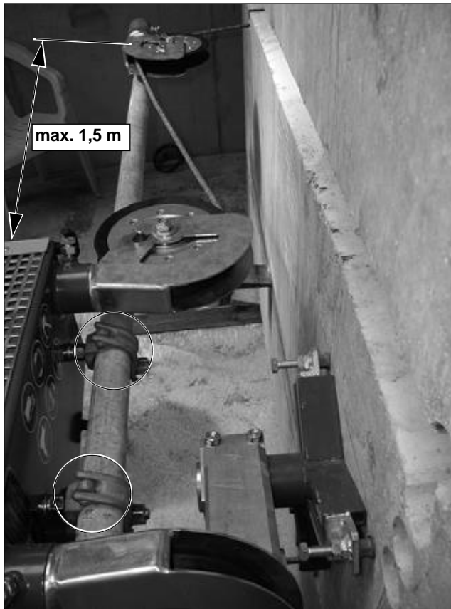
Bild 5.15 Bei Bedarf, auf dem (optionalen) Montagerohr, entsprechende (optionale) Umlenkrolle, bis max. 1,5 m Abstand, ohne zusätzliche Abstützung, zum CSA•100 - Montagefuß montieren
