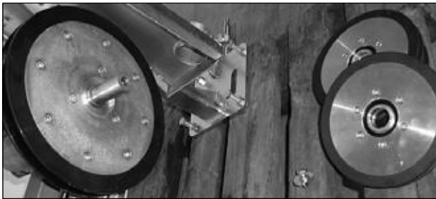
Bild 8.2 Speicher-Rollen vom CSA•100 Seil-Treibrad-Wellenstumpf abgezogen
