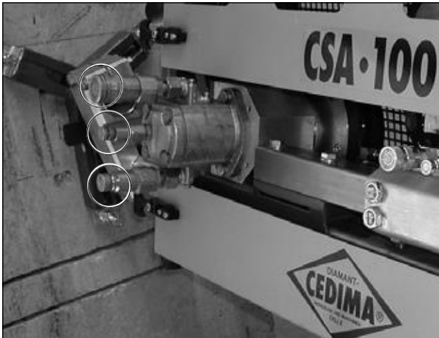
Bild 5.48 Anschlüsse am hydraulischen Seil-Treibradmotor, CSA•100 H
