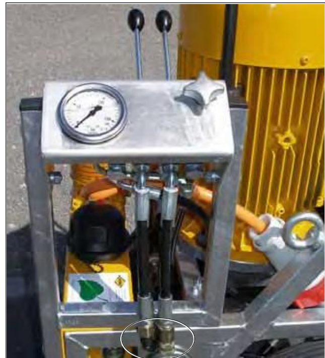
Bild 5.51 Kupplungen (der 2 möglichen Steuerblöcke) für den hydraulischen CSA•100 H Vorschub am (unter dem) Steuerpult des optionalen Hydraulikaggregat HAG•12.20
