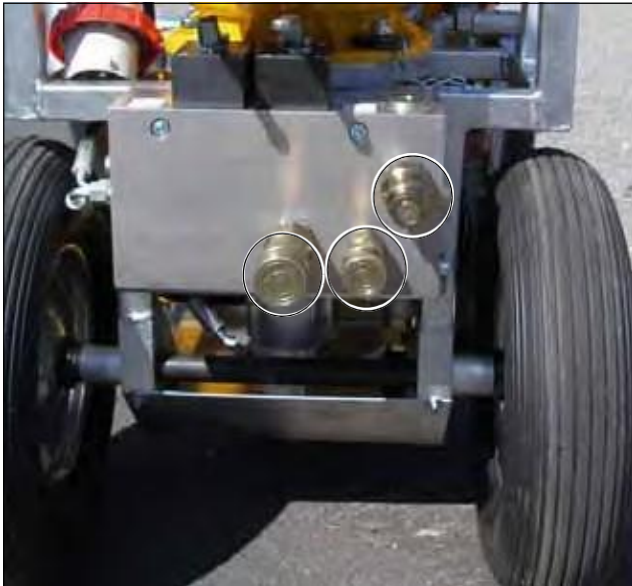
Bild 5.53 Optionales Hydraulikaggregat HAG•12.20, Anschlüsse zum hydraulischen Seil-Treibradmotor, CSA•100 H
