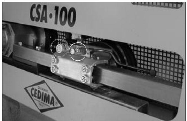
Bild 5.46 Anschlüsse des Vorschub-Hydraulik-systems, am CSA•100 (H) Führungsschlitten
