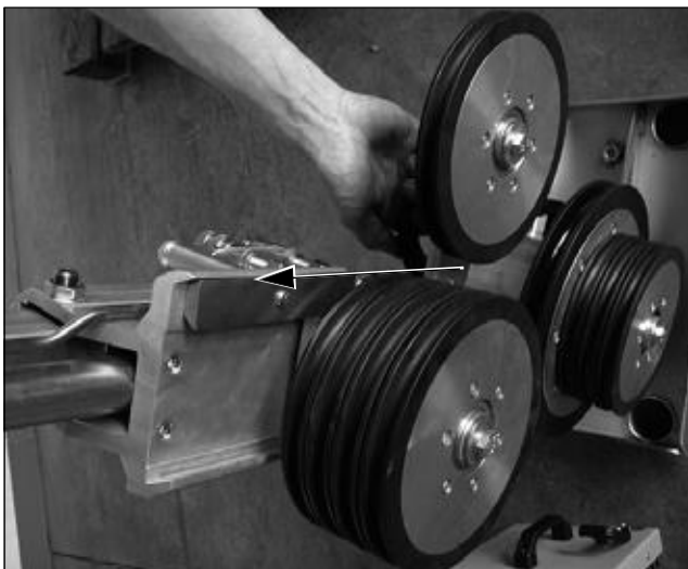
Bild 5.13 (Hinteres) Rollenpaket auf den Führungsschlitten schieben
