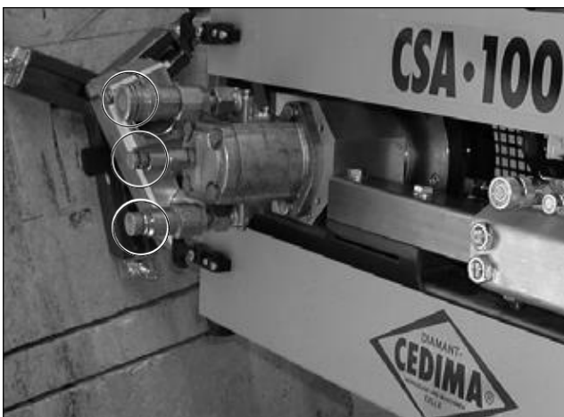
Bild 5.54 Anschlüsse am hydraulischen Seil-Treibradmotor, CSA•100 H
