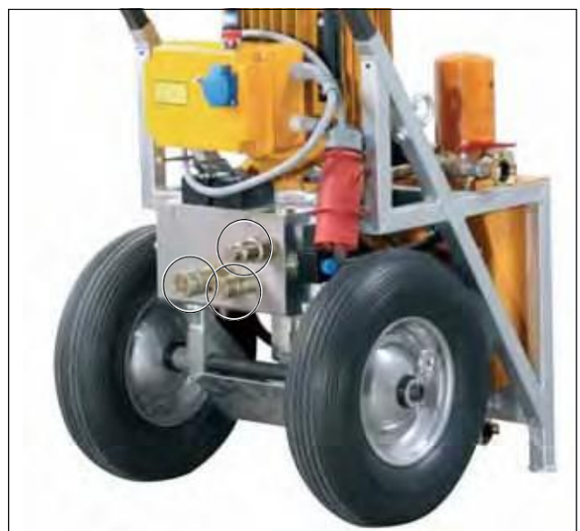
Bild 5.47 Optionales Hydraulikaggregat HAG-324, Anschlüsse zum hydraulischen Seil-Treibrad-motor, CSA•100 H
