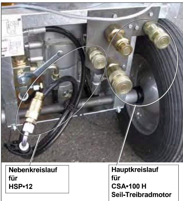
Bild 5.40 Hydraulik-Anschlüsse am HAG•12.10
