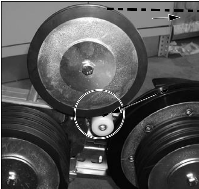
Bild 5.17 Sägeseil zwischen CSA•100 Umlenkrolle und Stützrolle führen
