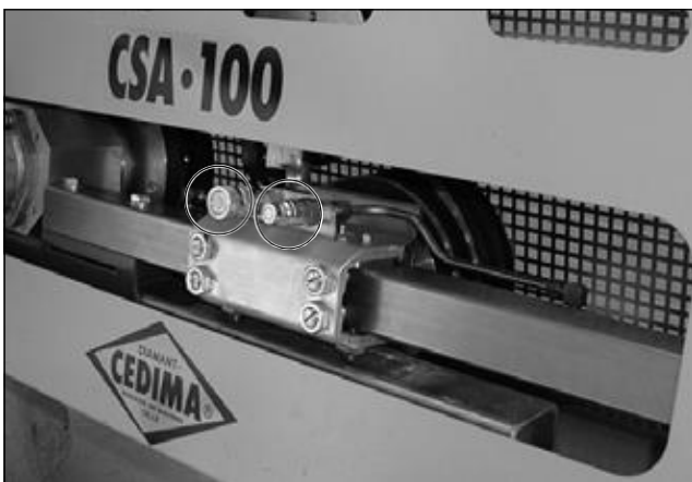
Bild 5.39 Anschlüsse des Vorschub-Hydrauliksystems, am CSA•100 (H) Führungsschlitten
