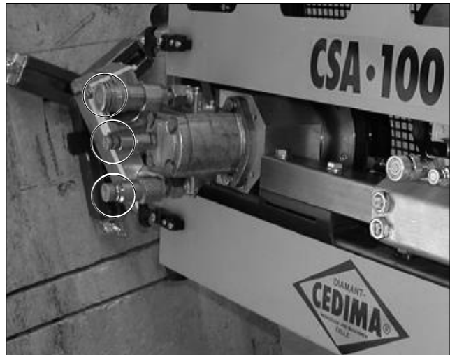
Bild 5.41 Anschlüsse am hydraulischen Seil-Treibradmotor, CSA•100 H
