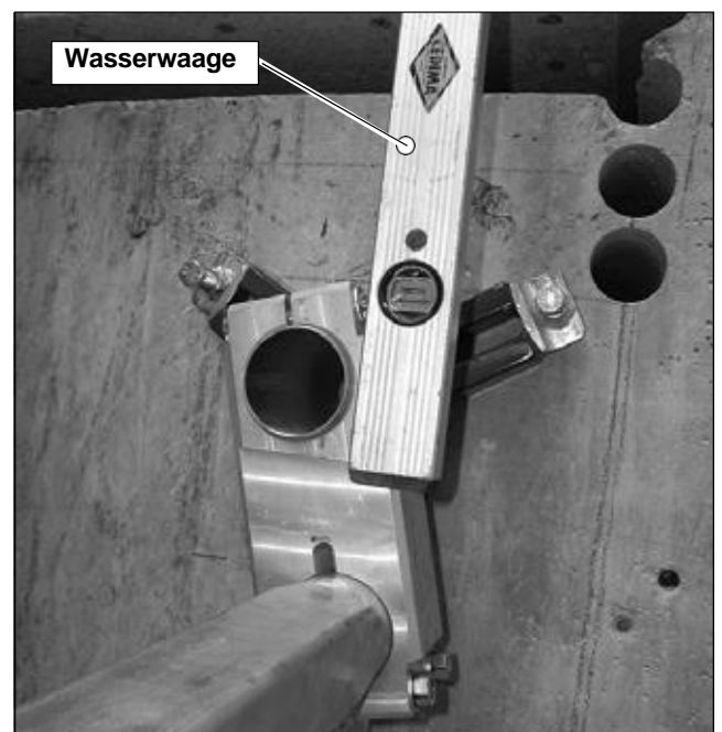
Bild 5.5 Schwenkgelenk, Montagerohr auf dem CSA•100 Präzisions-Schwenkfuß ausrichten
