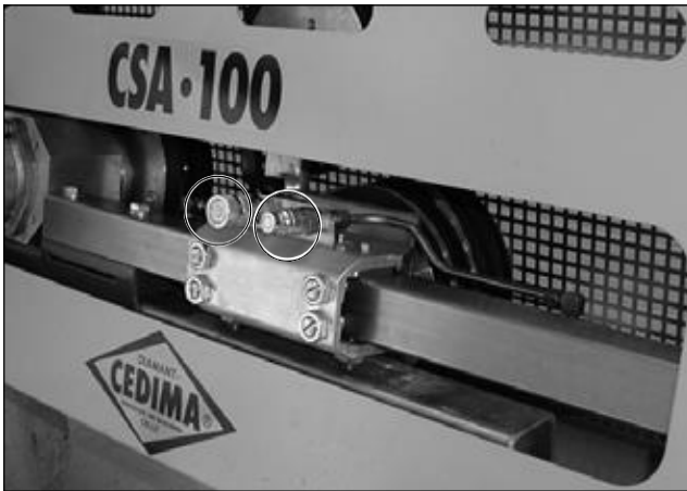
Bild 5.52 Anschlüsse des Vorschub-Hydrauliksystems, am CSA•100 (H) Führungsschlitten
