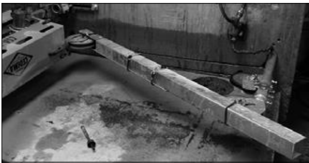
Bild 5.29 Schutzprofile auf Seilführungs-Vorrichtung (lang, mit Minischwenkrolle) und CSA•100 (Mini-) Schwenkrolle montiert
